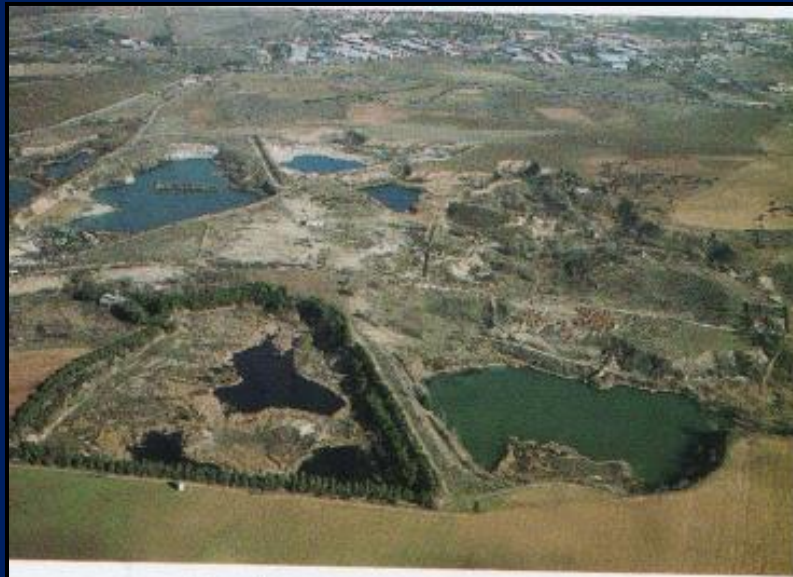
Muchas de las arenas y gravas utilizadas como áridos se extraen de depósitos fluviales. Son las graveras.
